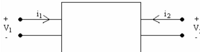
**Figura 5.3.6.** Linealidad y superposición. (Circuito de 2 pares de terminales)
